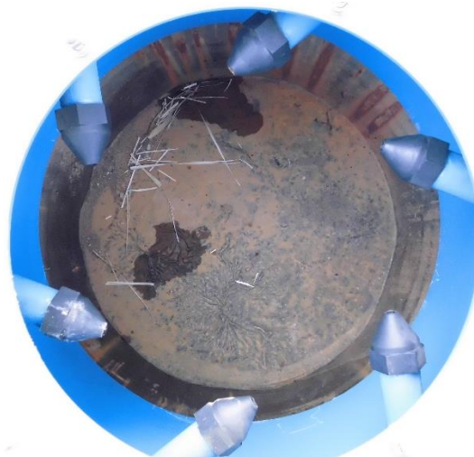
B. Injecteurs du bloc Turbine
